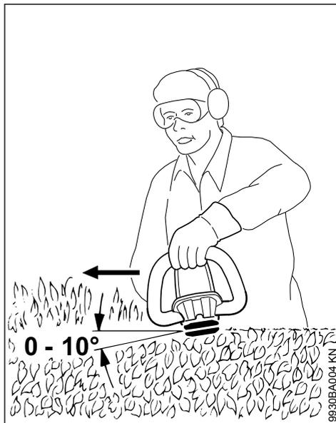
Posicionar a lâmina de corte num ângulo de  $0^\circ$  até  $10^\circ$ , mas conduzir a máquina na horizontal.
