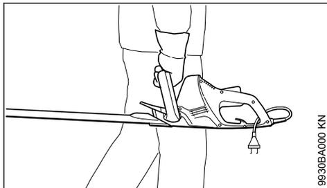
Transportar a máquina pelo punho – lâminas de corte para trás.
