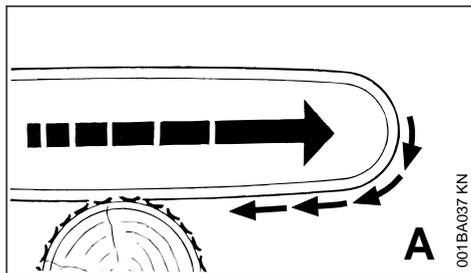
Se, ao serrar com a parte inferior do sabre - de cima para baixo - a corrente enroscar ou encontrar um obstáculo na madeira, a motosserra pode ser puxada com violência na direção do tronco. **Para evitar isso, sempre manter o batente de garras fixado na máquina.**
