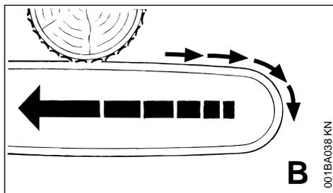
Se, ao serrar com a parte superior do sabre - de baixo para cima - a corrente enroscar ou encontrar um obstáculo na madeira, a motosserra pode voltar na direção do operador - **Para evitar o rebote:**
