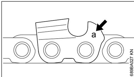
A identificação (a) do passo da corrente está gravada na área do limitador de profundidade de cada dente de corte.
