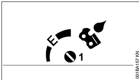
Com os pinos de regulagem (1) (na parte inferior da máquina) pode ser ajustada a quantidade de óleo, conforme necessário.
