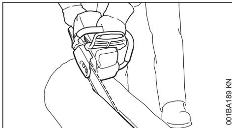
Na técnica de corte sem uso do batente de garras, há perigo de rebote. Utilizar o sabre em ângulo pouco profundo, tendo cuidado especial. Elevado **risco de rebote!**
