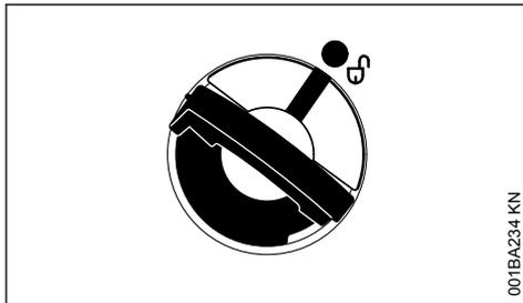
Marcações de posição na tampa do tanque e no tanque de combustível devem estar alinhadas
