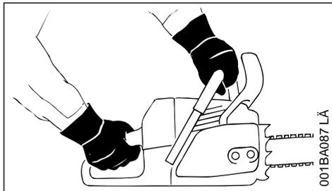
Sempre segurar a máquina **com as duas mãos**: mão direita no cabo traseiro, mesmo para canchotos. Para um manuseio seguro, envolver o cabo do punho e o cabo da mão firmemente com os polegares.
