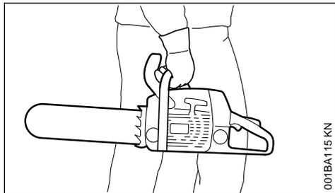
Segurar a máquina apenas pelo cabo do punho, mantendo o silenciador quente afastado do corpo e o sabre apontando para trás. Não encostar nas partes quentes da máquina, principalmente na superfície do silenciador. Perigo de queimadura!
