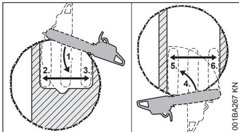
Realizar este corte de abate, quando o diâmetro do tronco for maior do que o comprimento do sabre.
