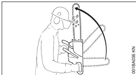
Em um rebote (kickback), a motosserra é lançada repentinamente e sem controle sobre o operador.
