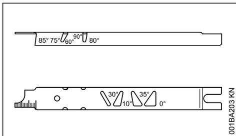
O calibre de correntes STIHL (acessório especial, veja tabela "Ferramentas para afiação") é uma ferramenta universal para controlar o ângulo de afiação e frontal, a altura do limitador de profundidade, o comprimento do dente de corte, a profundidade da ranhura e para limpar a ranhura e os furos da entrada de óleo.
